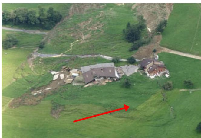
Ilustración 10: Superficie ondulada (flecha) indica la existencia de un deslizamiento permanente. A menudo faltan cauces en el área del cuerpo de deslizamiento debido a la deformación continua de la superficie. Fuente: GEOTEST AG.
