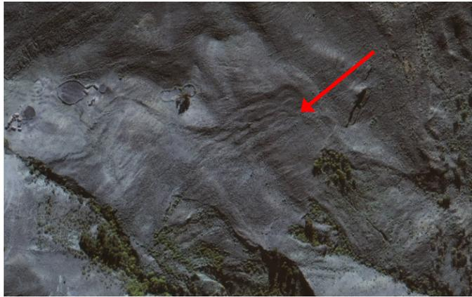
Ilustración 11: Fisuras profundas en el bosque con raíces tensas por una masa de tierra en movimiento. Fuente: CRS.
