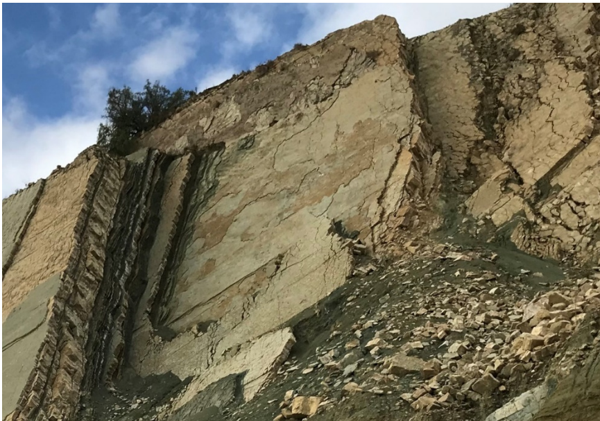
Ilustración 17: Análisis de las superficies rocosas – La cara de la roca tiene una estratificación muy inclinada paralela a la pendiente (parte izquierda). La parte derecha de la foto muestra las fisuras que atraviesan los estratos y por lo tanto definen el tamaño de las caídas.
