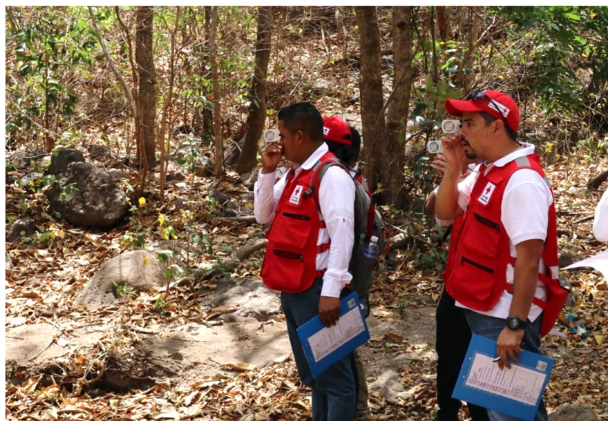
Ilustración 7: Levantamiento de la pendiente de una quebrada mediante clinómetro (Nacaome, Honduras). Fuente: CRS.
