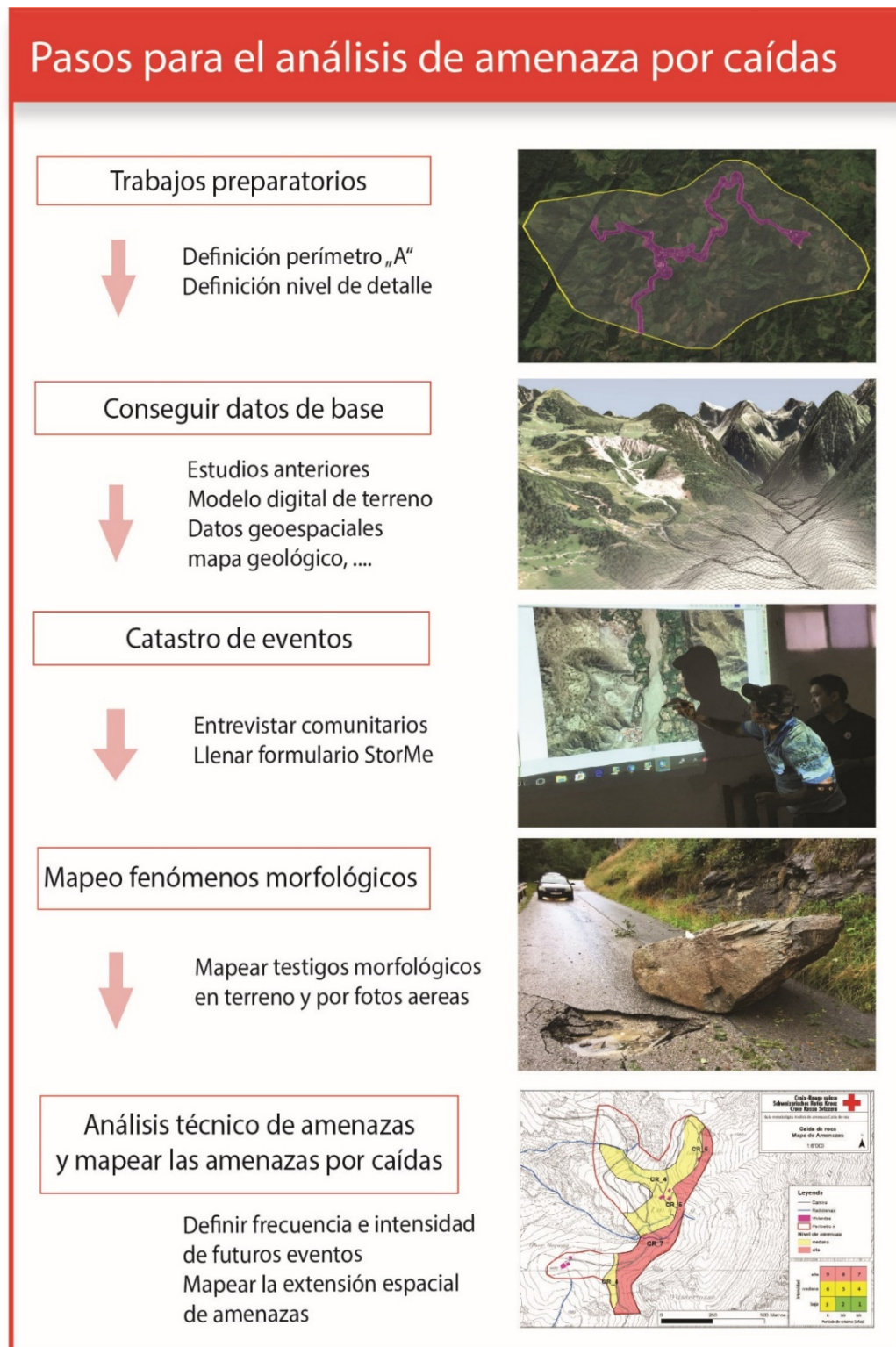
Ilustración 3: Pasos de trabajo para el análisis de amenazas por caídas de rocas. Fuente: CRS.
